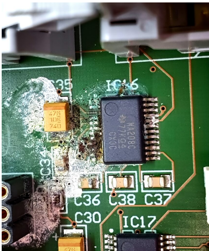
fot.1 Wygląd fragmentu płyty przed przystąpieniem do naprawy.
