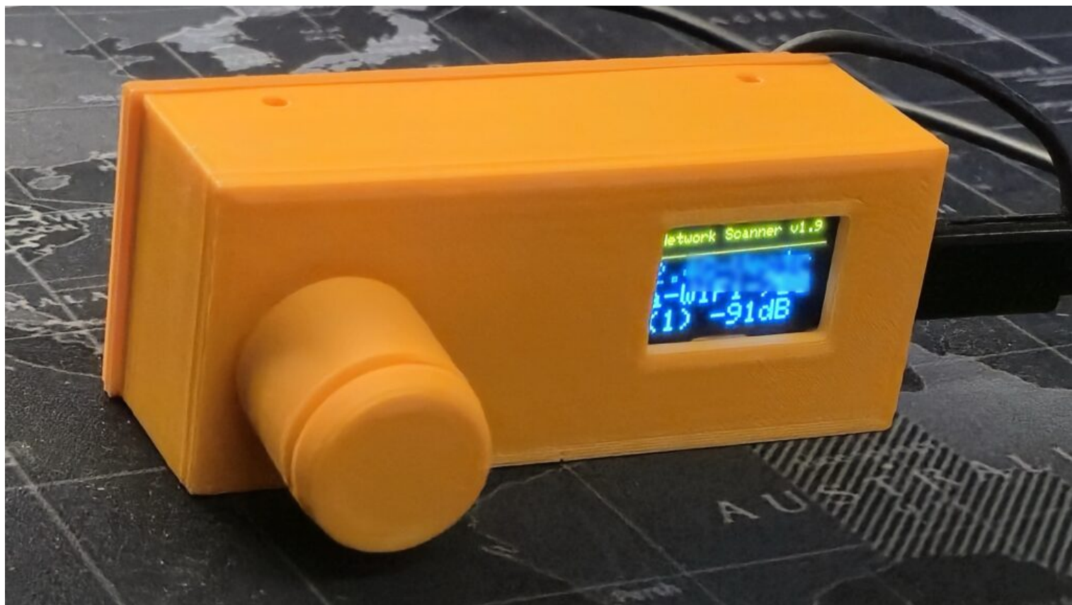
Skaner sieci WiFi z modułem ESP8266 i wyświetlaczem SSD1306 OLED 0,96"
